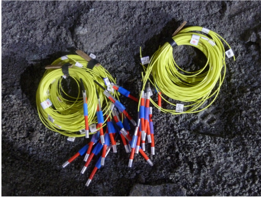
Abbildung 11: BOOSTER DX 80 mit montiertem Zünder; Quelle: SSE
