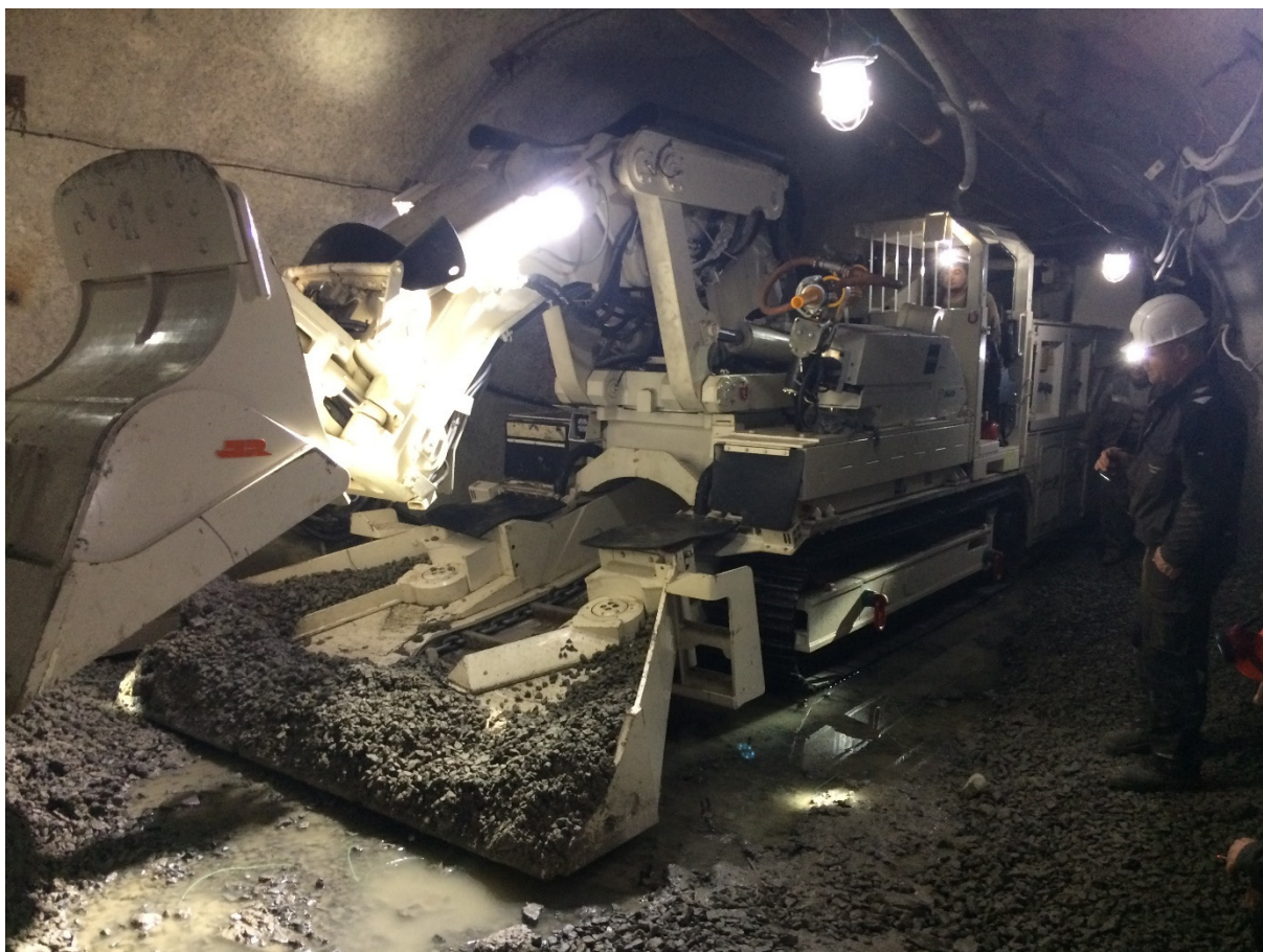
Abbildung 4: HRE mit obergriffiger Schaufel in Kasachaschtan untertage
