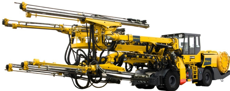
Abbildung 7: Vierarmiger Bohrwagen Boomer XE4 (Epiroc AB)
