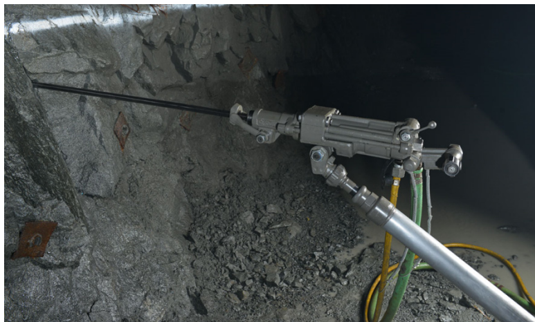
Abbildung 5: Druckluft-Bohrhammer mit Bohrstütze (Boart Longyear)
