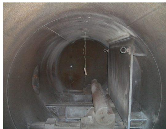
Abbildung 10: Blick in die 10 m 3 Prüfkammer mit Kantenmörser, Prallwand und frei hängender Wettersprengstoffpatrone Klasse I Quelle: RAG AG
