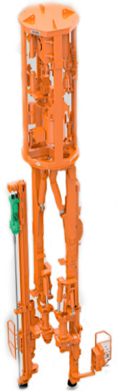
Abbildung 10: Teufen mit Hydraulik-Bohrhammer SJ155H (Komatsu/Joy)
