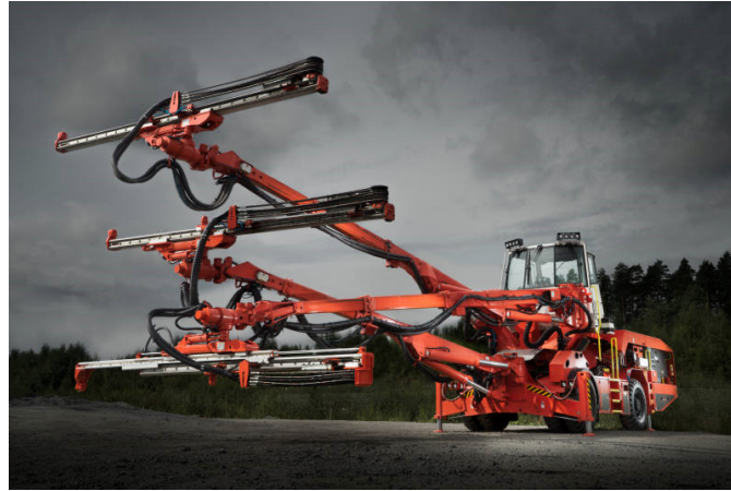
Abbildung 11: Dreiarmer Bohrwagen DT1331i (Sandvik AB)
