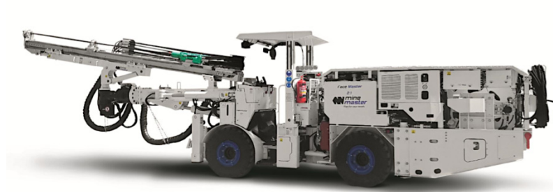
Abbildung 6: Einarmiger Bohrwagen Face Master (Minemaster)
