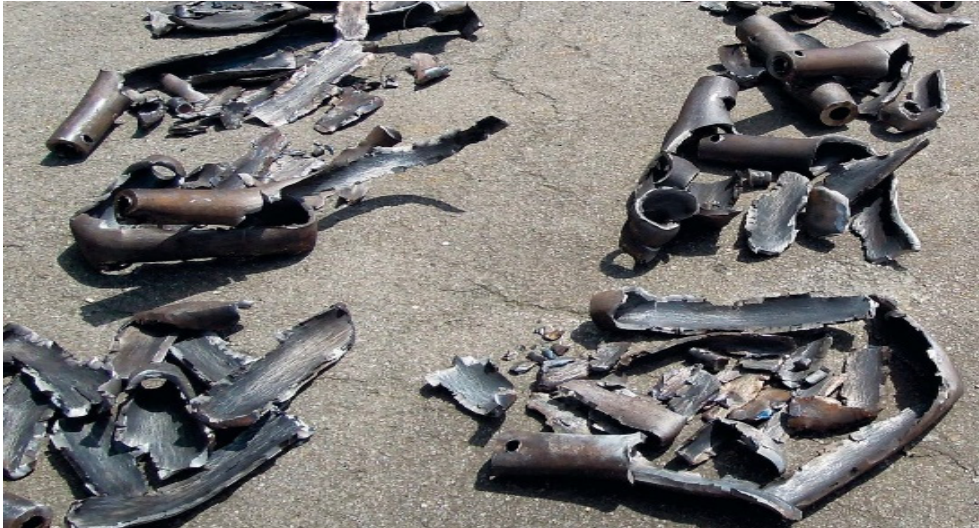
Abbildung 2: Splitter der Stahlrohre verschiedener Sprengversuche
