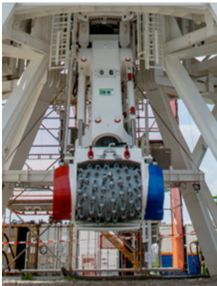
Abbildung 2: Detailansicht des Schneidauslegers
