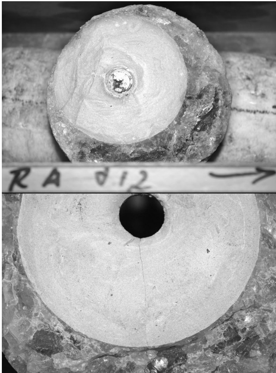
Abbildung 3: Bohrkern mit Baustoff IM-Asse-1 und Steinsalz Zugprüfungen im Baustoff einbetonierter Anker zur Untersuchung der Anbindung der Baustoffe an Steinsalzgebirge.
