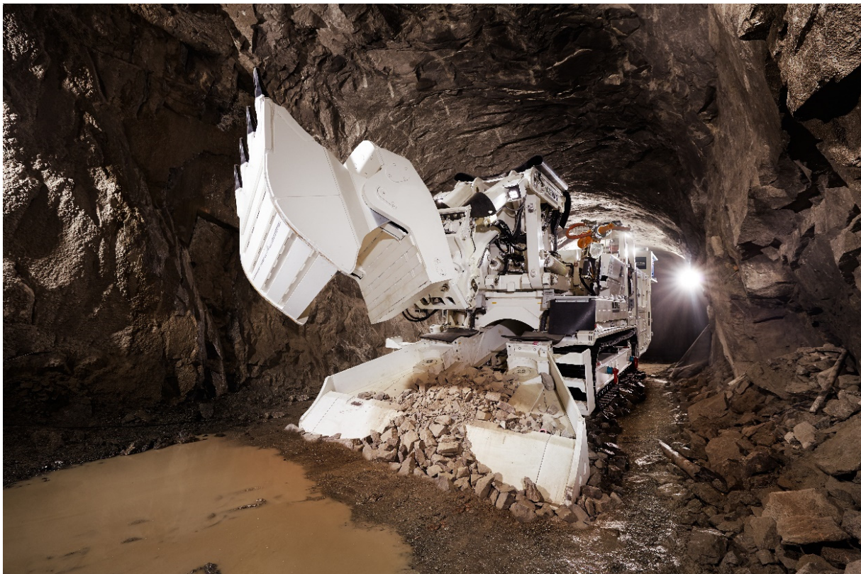
Abbildung 3: HRE mit untergriffiger Klappschaufel
