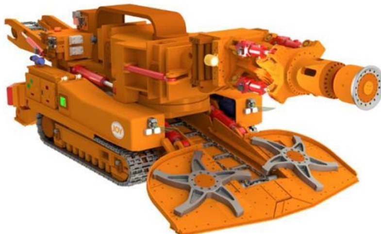
Abbildung 8: Der Komatsu DynaMiner mit einer aktivierten Schneiddiske nach dem DynaCut Prinzip (Komatsu Mining)
