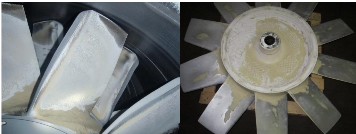
Abbildung 11: Abrieb an den Flügelspitzen
