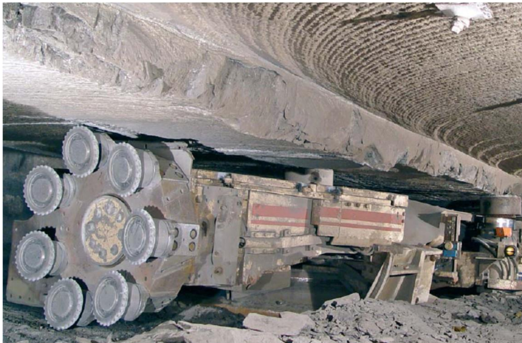
Abbildung 2: Sandvik Reef Miner MN 220 im Probeinsatz bei Longmin im UG2 Reef (Sandvik)
