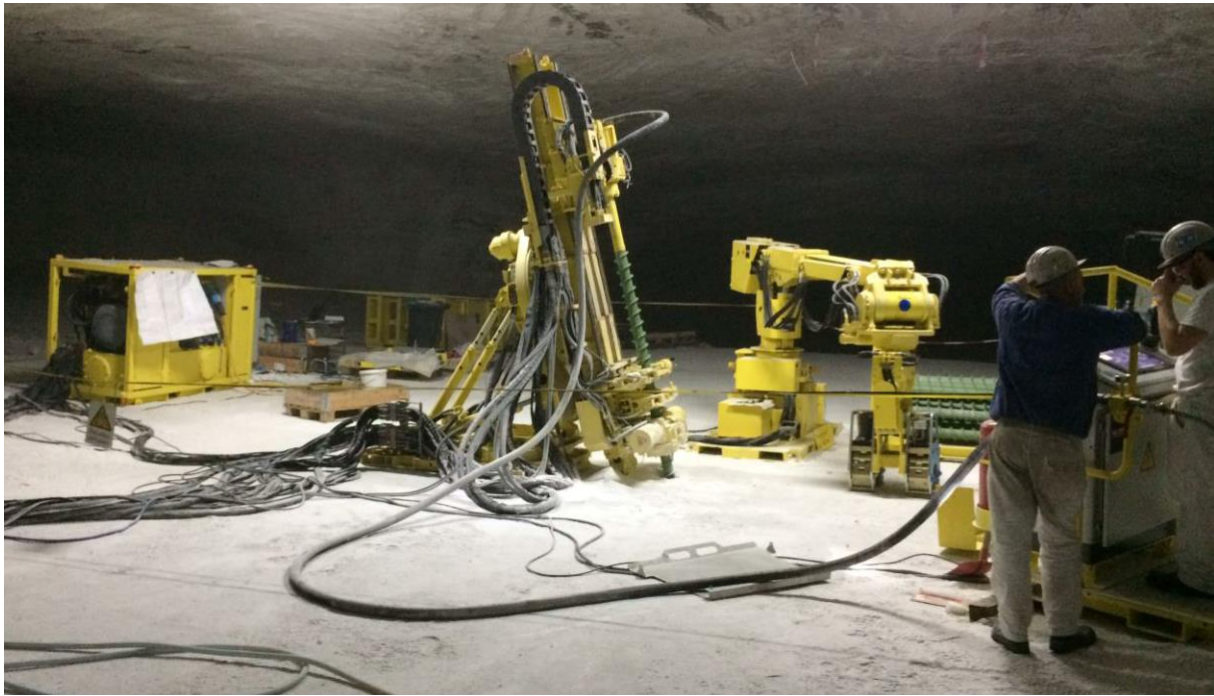
Abbildung 6: HLH 500 für Großlochbohrungen mit Durchmesser von 350 - 1.050 mm und Bohrlänge bis 150 m
