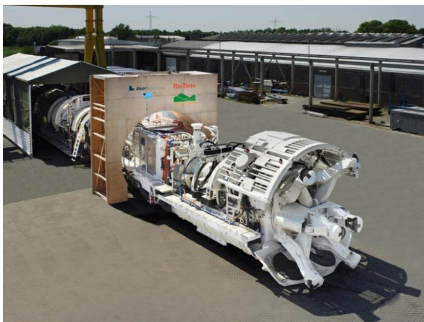
Abbildung 9: Aker Wirth Mobile Tunnel Miner MTM 6 Prototyp mit sechs Schneidarmen im Jahre 2012 (Aker Wirth)
