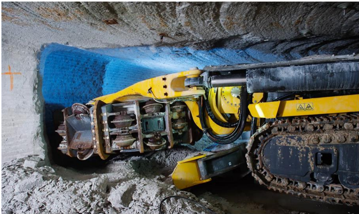
Abbildung 11: EPIROC Mobile Miner 22H im Einsatz im südafrikanischen Bergwerk Twickenham (EPIROC)
