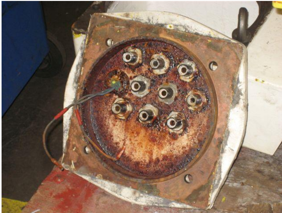
Abbildung 18: chemische Reaktion im Inneren
