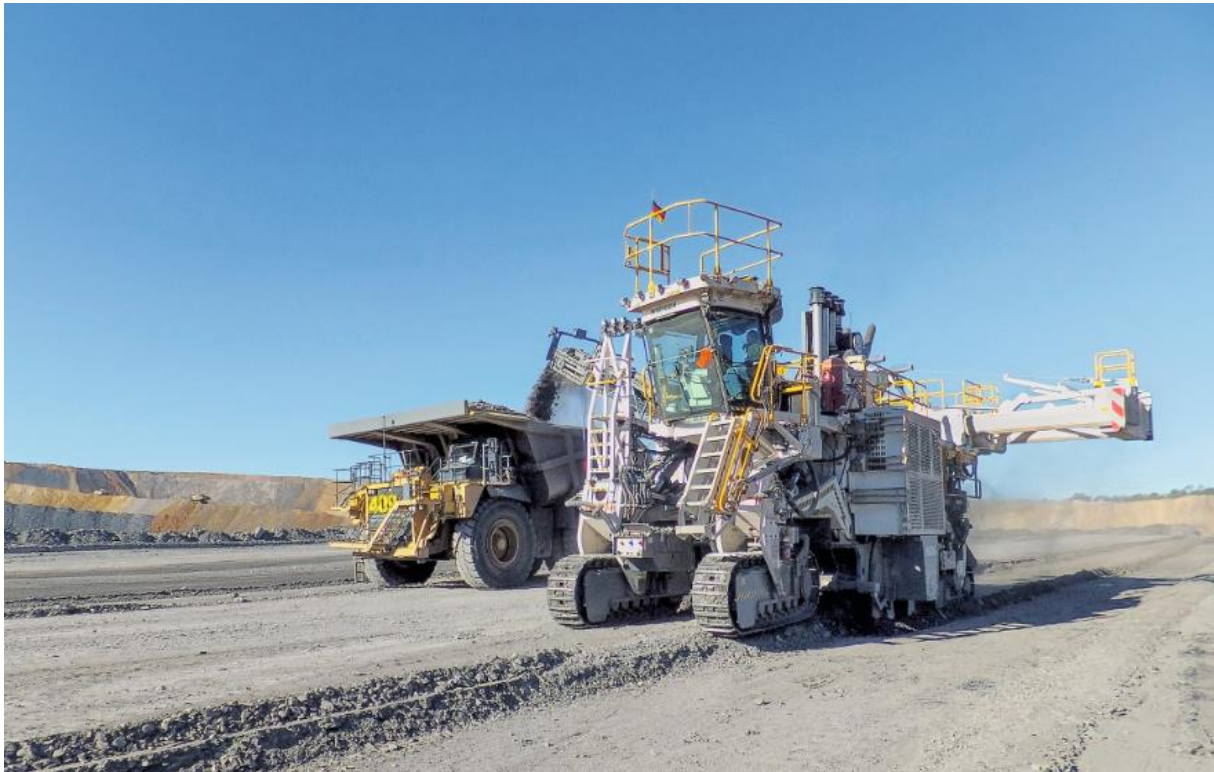
Abbildung 4: WIRTGEN Surface Miner schneidet und lädt direkt auf einen Muldenkipper (WIRTGEN)
