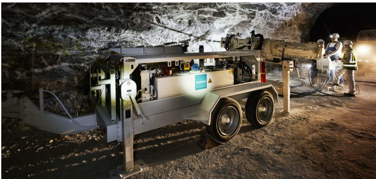
Abbildung 5: HLH 120 auf radmobilem Anhängerfahrzeug bei der Erstellung von Bohrungen für die Naherkundung
