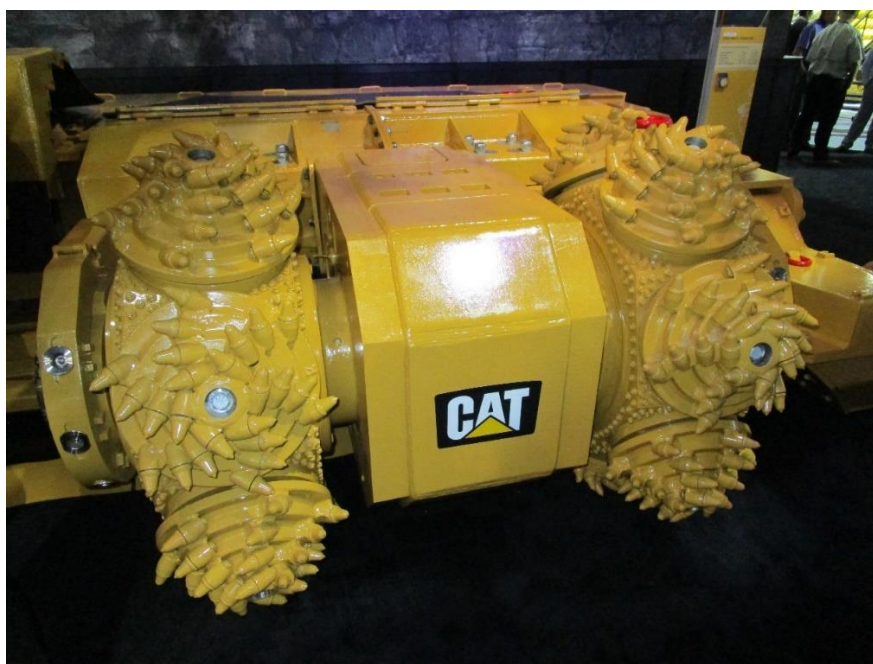
Abbildung 3: CAT Rock Straight System Walzenlader HRM220 mit zwei Schneidsystemen mit je 132 kW Antriebsleistung auf der Las Vegas Mining Show 2016 (Sifferlinger)
