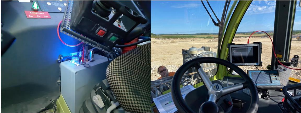
Abbildung 2: Unterbringung der Elektronikeinheit und Aufzeichnungsmonitor zur Visualisierung der Messergebnisse
