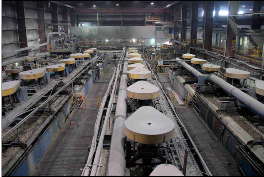
Abbildung 6: Am Ende des Aufbereitungsprozesses steht die Flotation
