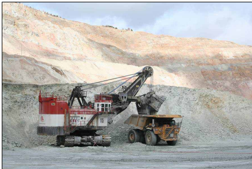
Abbildung 10: Seilbagger und SKW vor der Randböschung des Tagebaus
