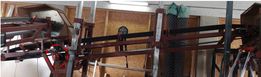
Abbildung 2: Gurtbandförderer der Testanlage mit eingebautem "PrimeTracker" – Tragseite
