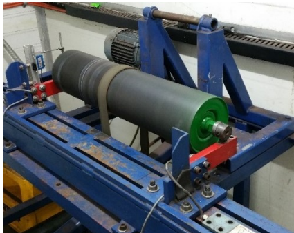
Abbildung 10: Testanlage für Rotationswiderstand der Tragrollen
