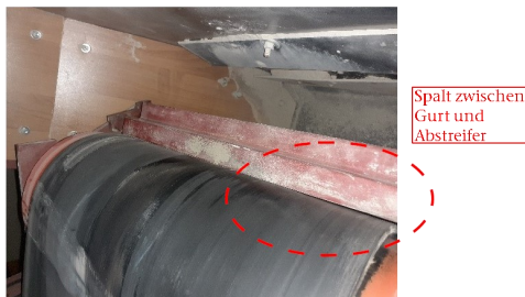
Abbildung 8: Ungleichförmig angepresster Gurtabstreifer [5]
