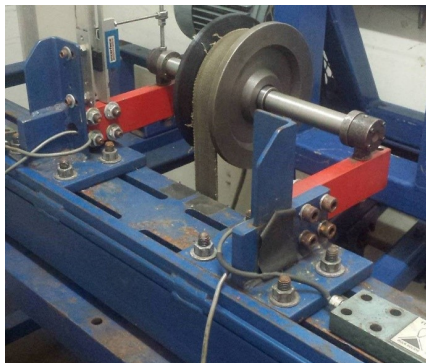
Abbildung 13: Testaufbau für Felgenwiderstandstest
