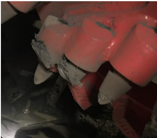
Abbildung 2 Stark beschädigte Rundschafftsmeißel nach 20cm Bohrtiefe
