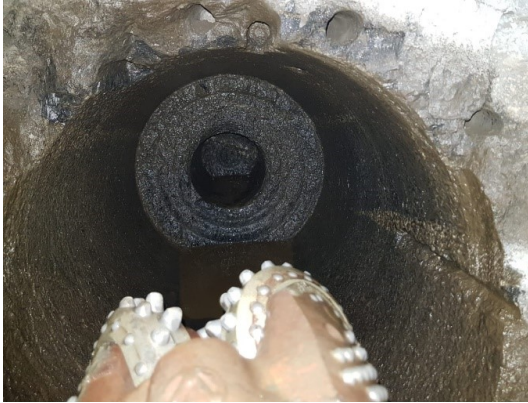
Abbildung 3: Bohrloch mit Tricone im Vorderrund
