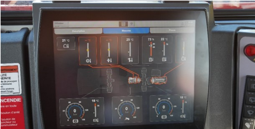
Abbildung 4: 12“ Touchscreen zur Anzeige der Betriebsdaten
