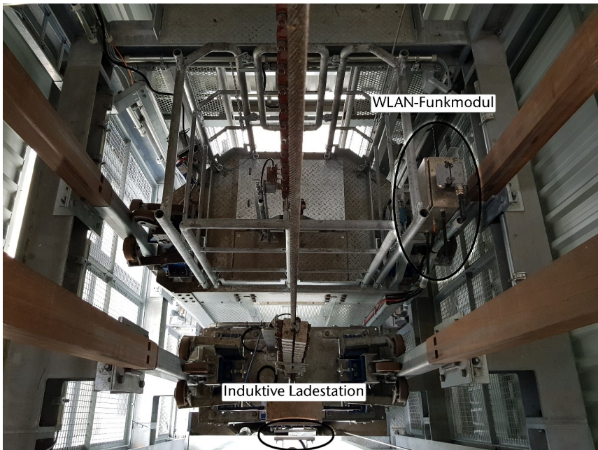
Abbildung 5: Die beiden Fördermittel im Führungsgerät. Mit WLAN Funkmodulen und induktiven Ladestationen
