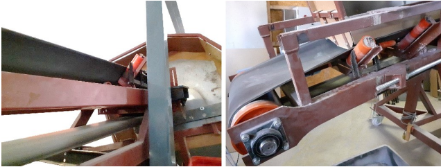
Abbildung 7: Mit Schraubzwingen blockierte Laufrollen [5]
