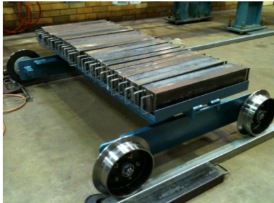
Abbildung 11: Testaufbau für Laufradwiderstandsmessungen
