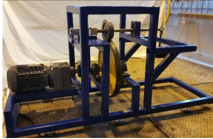
Abbildung 12: Testaufbau für Felgenwiderstand in Kombination zur Kontaktreibung
